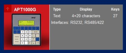
APT1000G 工业终端主要设计用于配电机/总机门上。标准的工业状态下, IP55 是前面板的终端保护。背光 LCD 显示可以调整下背光的密度以及很好的显示和对比数据信息。日光灯显示版本具有更好的可读性以及适用于更高的操作温度。拥有薄膜按键并且具有力学的按钮响应的体感。
