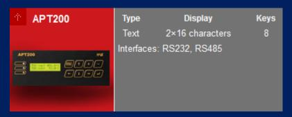
最小的且最简单的针对角色的工业终端,非常适用于简单的信息查看。8个按键控制以及数据设置。状态控制按钮使用两个颜色的 LEDs 在边框显示。RS232 和 RS485 不需要电隔离就可以连接终端和控制系统。此工业终端可以悬挂在门框并提供 IP55 保护。
